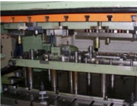
Presse mit Mehrstufenwerkzeug für Herstellung der Halterungen
